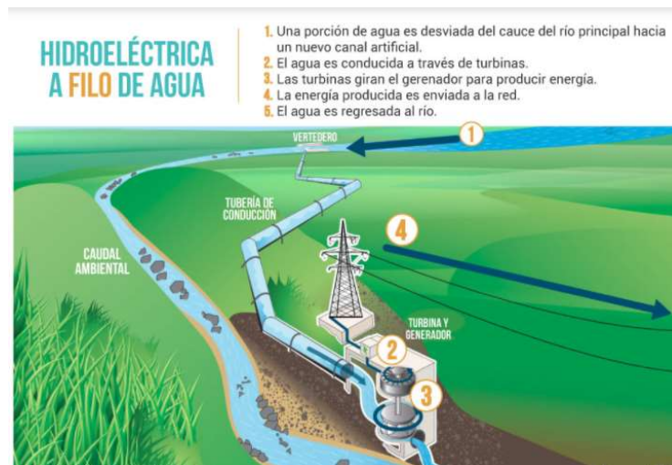
Figura 4. Hidroeléctrica a filo de agua.
